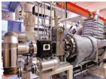
Die neue ACX-Anlage ermöglicht bei Hochleistungs-Acrylaten hohe Schichtdicken mit stärkerer Klebkraft auf neuen Trägermaterialien. Das eröffnen Tesa neue Anwendungsfelder mit hohem Potenzial. Bild: Tesa
